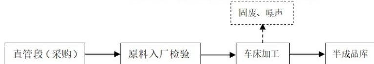
图 3-10 压力、压差变送器工艺流程及产污位置图
