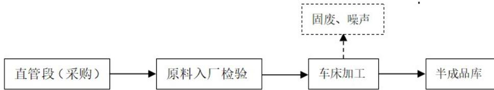
图 3-11 差压流量计工艺流程及产污位置图
