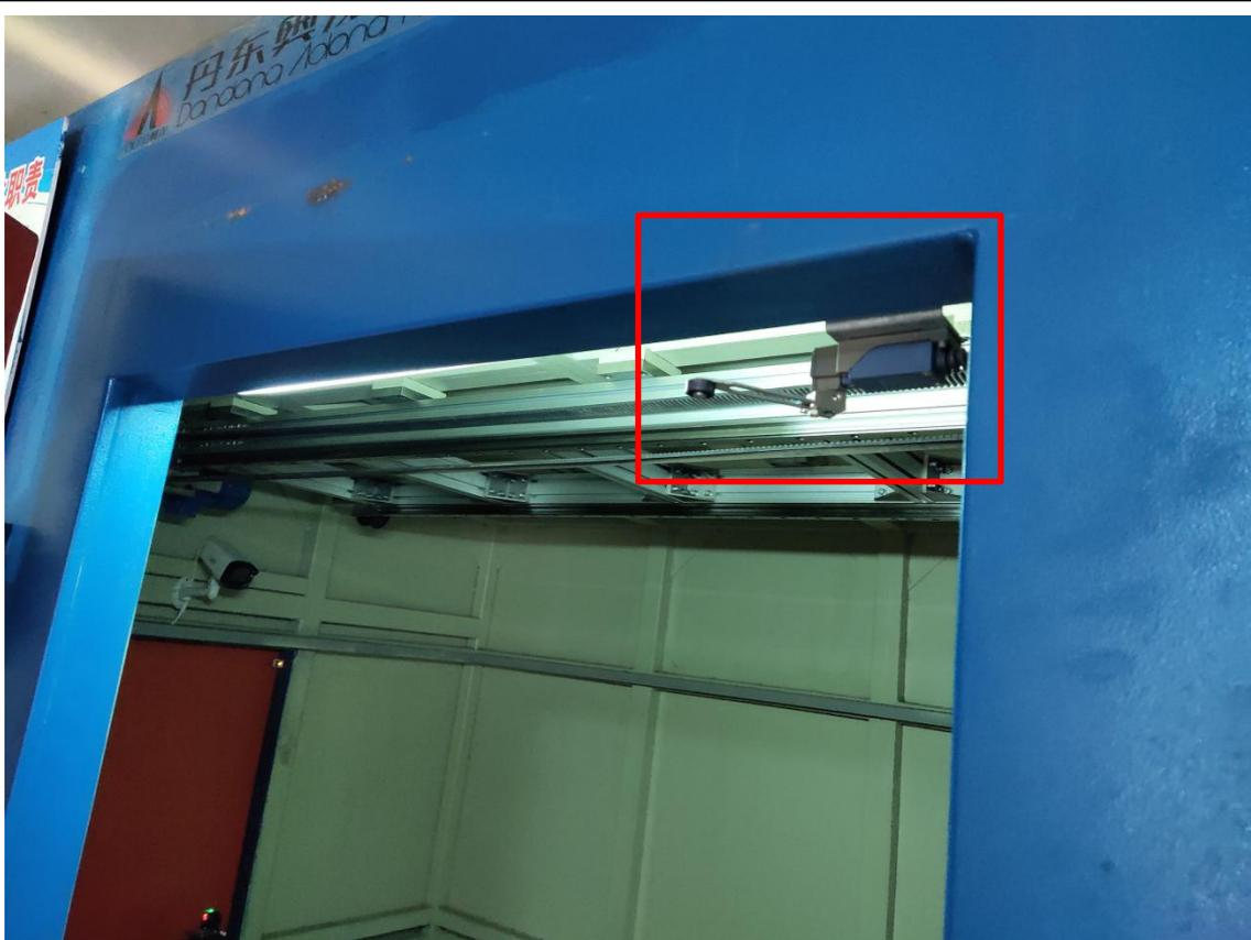
门机联锁装置限位开关
